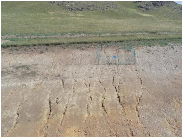
图 1.3-9 侵蚀沟样方测量法 (I)
