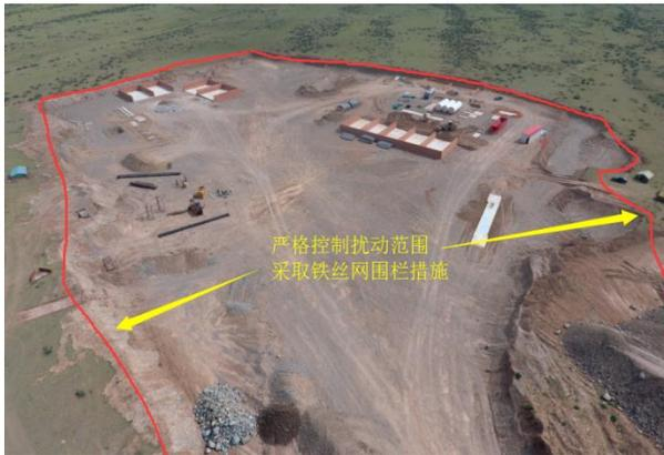
图4.3-7 施工场地铁丝网围栏
