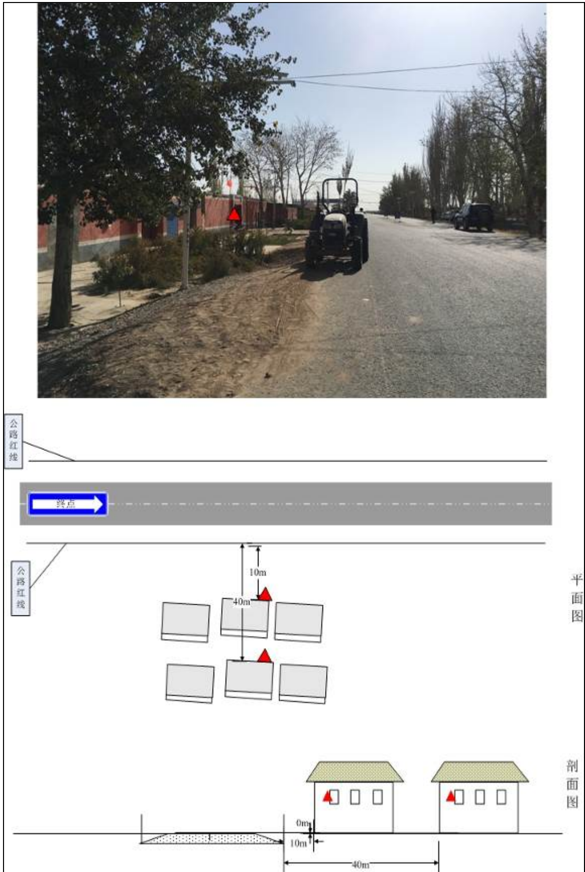
图 6.2 买里塔木村临路第一排和第二排声环境现状监测点位布设示意图
