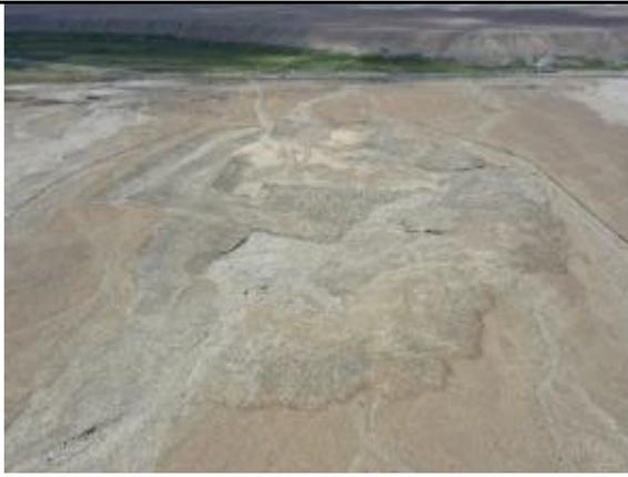
**S13 取土（料）场：**采取了斜坡防护工程、土地整治工程；目前已移交
