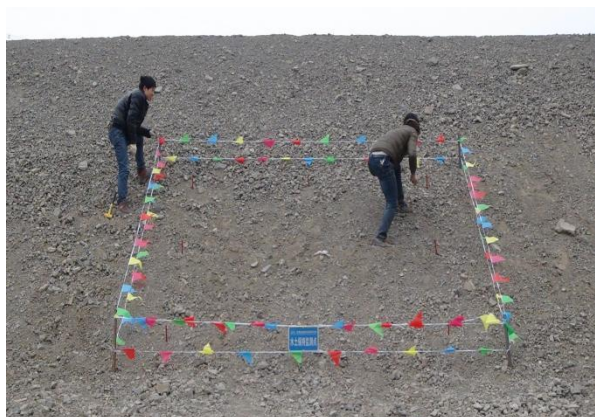
图 2.2-1 路基边坡观测小区布设
